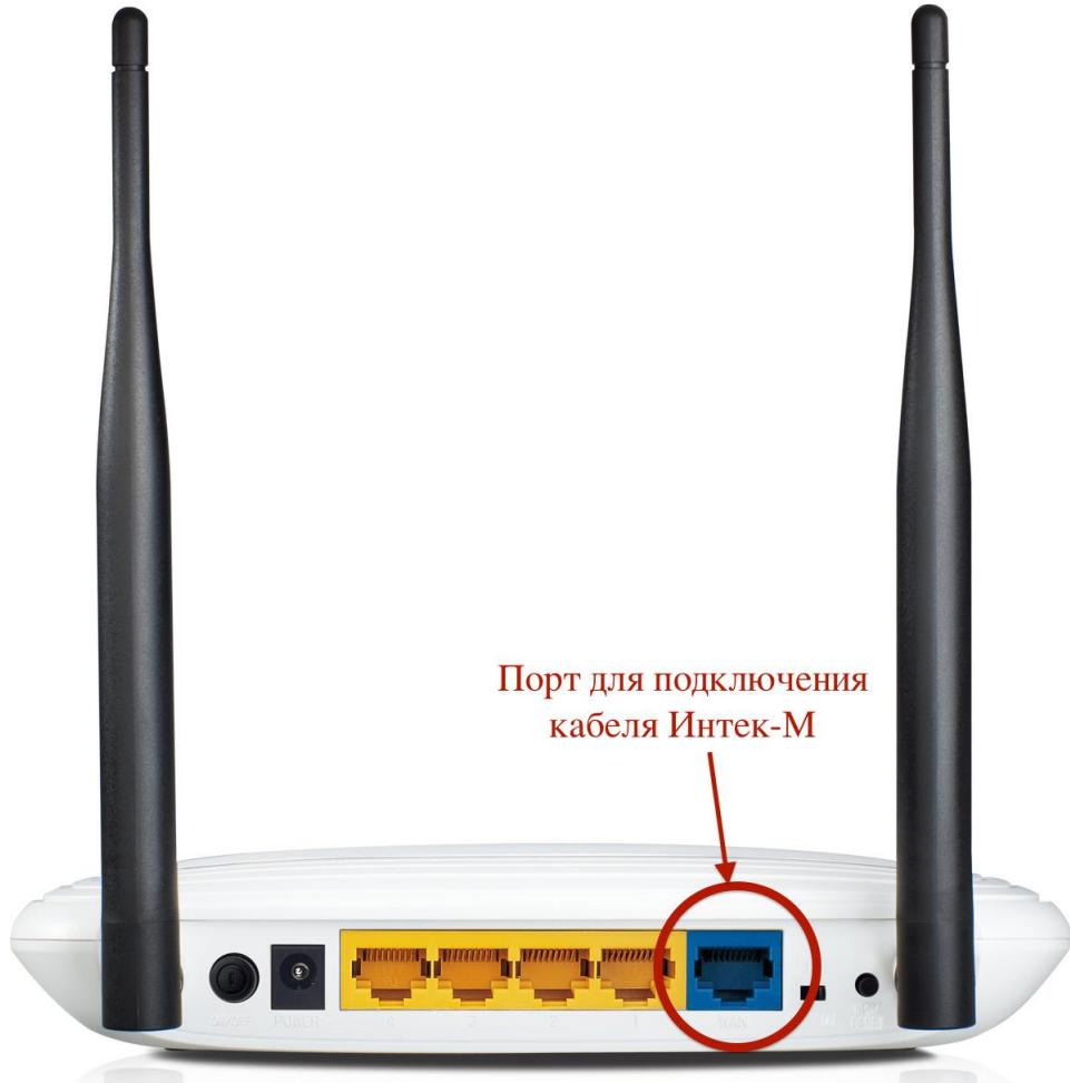
В комплекте роутера есть кабель (патч-корд) с таким же разъёмом, как и кабель, предоставляемый нашей компанией. Этим кабелем или другим патч-кордом нужно подключить роутер в сетевую карту компьютера (она имеет такой же разъём, как порты на задней панели роутера). Патч-корд надо подключить в любой из 4-х LAN- портов роутера.
